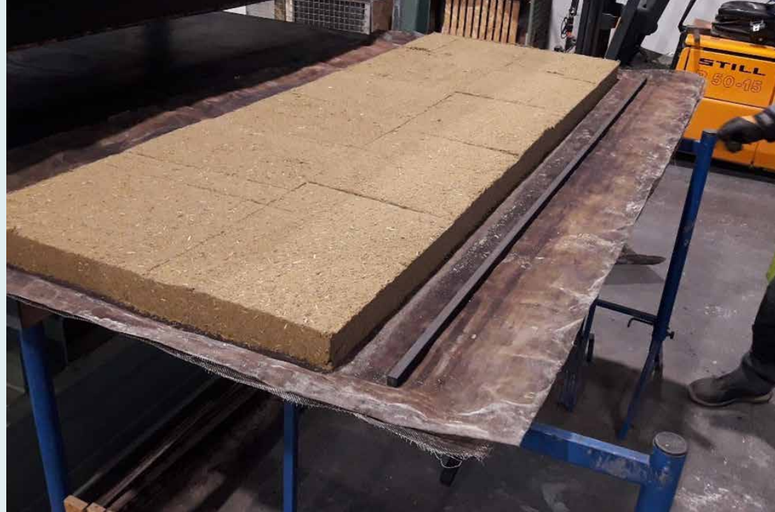
▲ Fabricage van plaatmateriaal van lisdodde voor persing.
