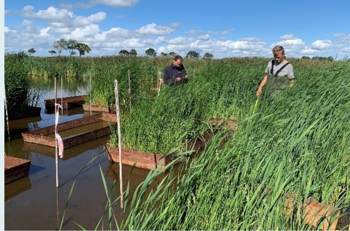
▲ Proefopstelling met stalen bakken in het Zuiderveen.
