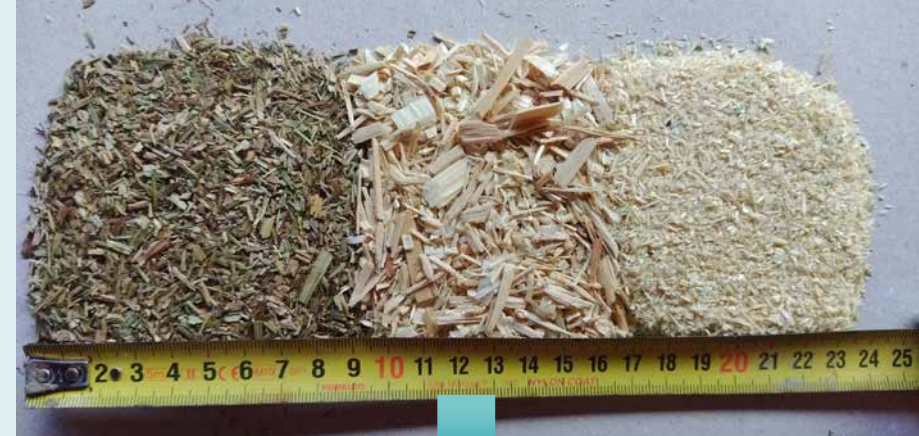
▲ Diverse vezels waaronder oeverzegge (links) ten behoeve van de fabricatie van plaatmateriaal.
