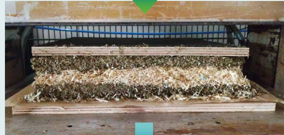
▲ Persen van plaatmateriaal met aan de buitenzijde een mix met oeverzegge.
